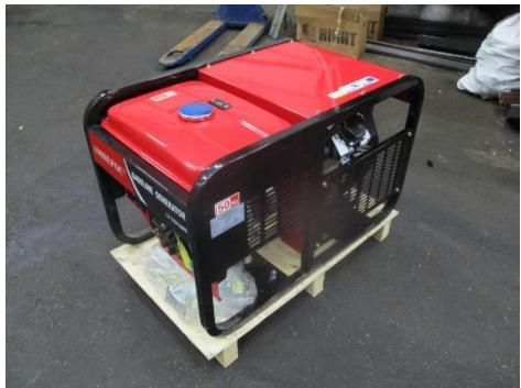
Бензиновая генераторная установка трехфазная номинальной мощностью 11 кВт \ максимальной мощностью 12 кВт (15 кВА) с электростартером, аккумулятором и системой автозапуска. Возможна установка подогрева масла в картере двигателя.
