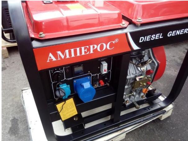
Дизельная генераторная установка трехфазная максимальной мощностью 8 кВт/10 кВА с электростартером и аккумулятором. Дизель 3000 об\мин, воздушного охлаждения с предпусковым подогревателем воздуха.
