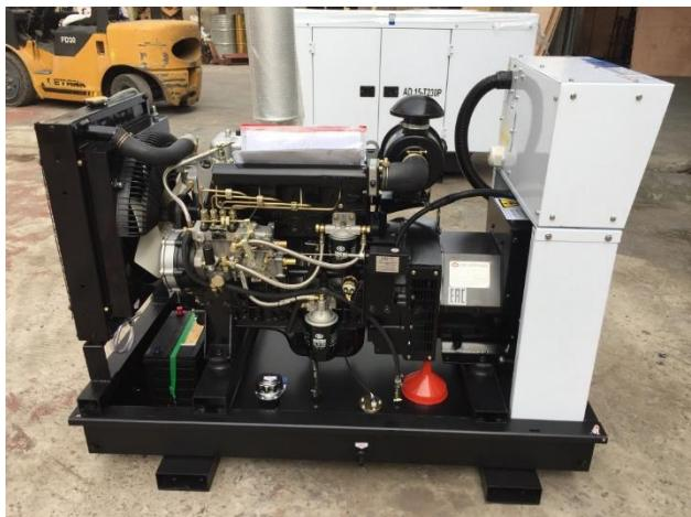
Дизель генератор мощностью 50 кВт / 55 кВт. Дизель Амперос Проф 1500 об\мин жидкостного охлаждения для интенсивной эксплуатации. Топливный бак на 24 часа работы. Гарантия 2 года.
