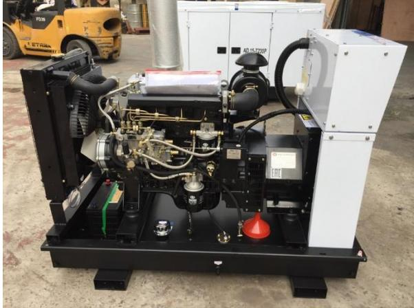
Дизель генератор мощностью 15 кВт / 16,5 кВт.
