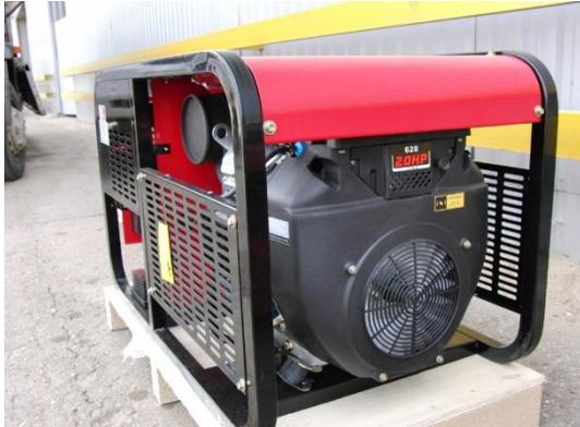
Бензиновая генераторная установка однофазная номинальной мощностью 8,5 кВт \ максимальной мощностью 9,5 кВт с электростартером, аккумулятором и блоком автозапуска. Возможность установки подогрева масла в картере двигателя.
