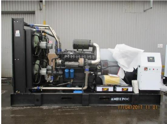
Дизель генератор мощность - 2500 кВА/2000 кВт.
