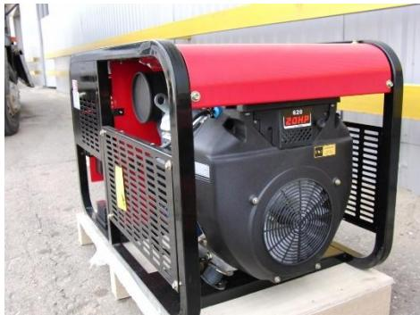
Бензиновая генераторная установка трехфазная номинальной мощностью 10 кВт \ максимальной мощностью 11 кВт (13,7 кВА) с электростартером, аккумулятором и системой автозапуска. Возможна установка подогрева масла в картере двигателя.
