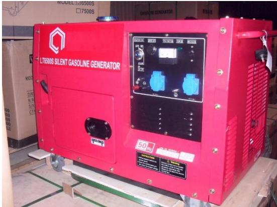
Бензиновый генератор в шумозащитном кожухе однофазная номинальной мощностью 4,5 кВт \ максимальной мощностью 5 кВт с электростартером и аккумулятором.
