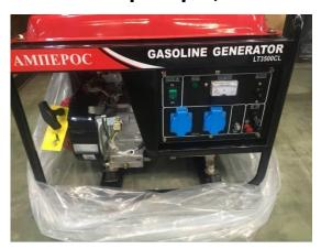
Бензиновый генератор однофазный номинальной мощностью 2,5 кВт/ максимальной мощностью 2,8 кВт. Топливный бак 15л.
