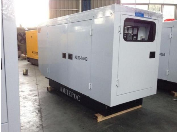
Дизель генератор мощностью 10 кВт / 11 кВт в шумозащитном кожухе. Дизель Амперос 1500 об/мин жидкостного охлаждения.
