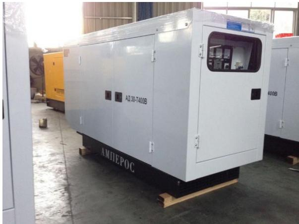
Дизель генератор мощностью 16 кВт / 20 кВА для интенсивной эксплуатации. Дизель АМПЕРОС 1500 об\мин жидкостного охлаждения. Топливный бак на 40 часов работы. Гарантия 2 года.
