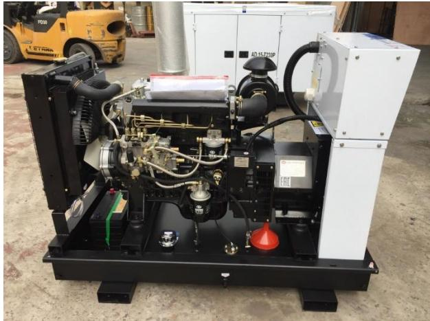
Дизель генератор мощностью основного применения 70 кВт. Дизель Ricardo 1500 об\мин жидкостного охлаждения.
