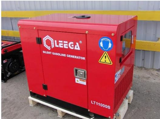
Бензиновая генераторная установка в шумозащитном кожухе однофазная номинальной мощностью 8,5 кВт \ максимальной мощностью 9,5 кВт с электростартером, аккумулятором и блоком автозапуска. Возможность установки подогрева масла в картере двигателя.
