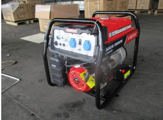
Бензиновая генераторная установка однофазная номинальной мощностью 7,0 кВт \ максимальной мощностью 7,5 кВт с электростартером, аккумулятором и блоком автозапуска при пропадании основной сети.
