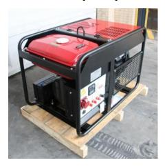
Бензиновая генераторная установка трехфазная номинальной мощностью 13 кВт \ максимальной мощностью 15 кВт (18,7 кВА) с электростартером, аккумулятором и системой автозапуска. Возможна установка подогрева масла в картере двигателя.
