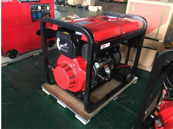
Дизельная генераторная установка однофазная максимальной мощностью 8 кВт с электростартером и аккумулятором. Дизель 3000 об\мин, воздушного охлаждения с предпусковым подогревателем воздуха.
