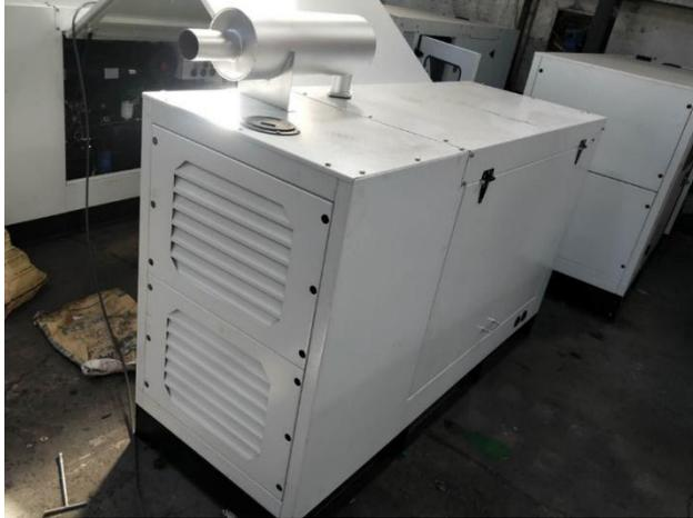
Дизель генератор мощностью 100 кВт / 110 кВт. Дизель Ricardo 1500 об/мин жидкостного охлаждения.
