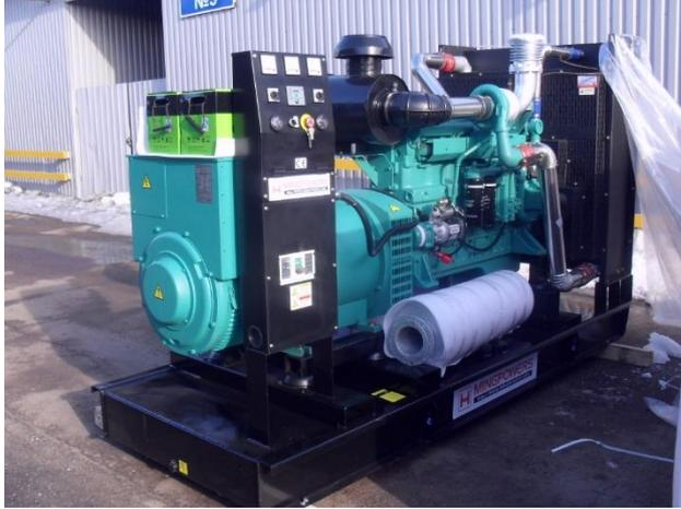
Дизель генератор мощность - 275 кВА/220 кВт (резервного применения), 250 кВА/200 кВт (основного применения). Дизель SDEC 1500 об/мин жидкостного охлаждения. Дизель генератор для интенсивной эксплуатации.
