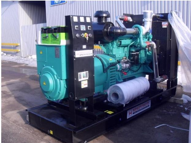
Дизель генератор основная мощность- 450 кВА/360 кВт , резервная мощность - 500 кВА/400 кВт. Дизель SDEC.
