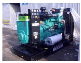
Дизель генератор основная мощность - 500 кВА/400 кВт, резервная мощность - 550 кВА/440 кВт . Дизель CUMMINS.
