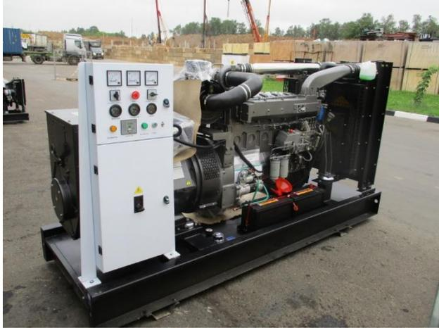
Дизель генератор мощностью 120 кВт / 132 кВт. Дизель Ricardo 1500 об/мин жидкостного охлаждения.
