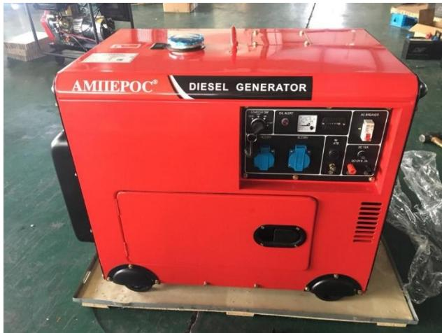
Дизельная генераторная установка в шумозащитном кожухе трехфазная максимальной мощностью 7 кВт/8,7 кВА с электростартером , аккумулятором и автоматическим запуском. Дизель 3000 об\мин, воздушного охлаждения. Возможна установка подогрева масла в картер двигателя.
