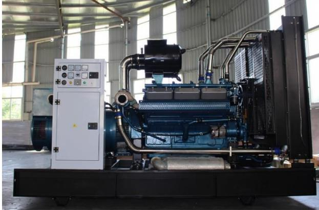
Дизель генератор максимальной мощностью - 826 кВА/661 кВт, основная мощность 751 кВА/601 кВт. Дизель KÖGEL 1500 об/мин.
