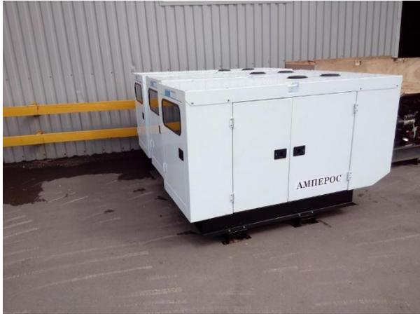
Дизель генератор мощностью 30 кВт / 33 кВт.
