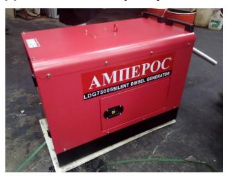
Дизельная генераторная установка в шумозащитном кожухе трехфазная максимальная мощность 6 кВт с электростартером и аккумулятором с блоком автоматического запуска. Дизель 3000 об\мин, воздушного охлаждения. Возможна установка подогревателя масла в картер двигателя.
