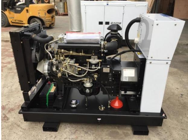
Дизель генератор мощностью 12 кВт/13 кВт.
